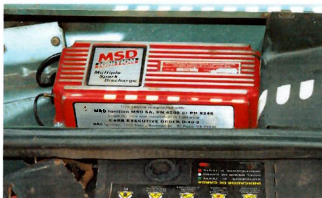
Fig.44-Módulo de ignição MSD 6A
