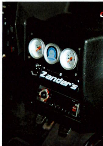
fig.64-Relógio de pressão de combustível, hallmeter e pressão de óleo.
