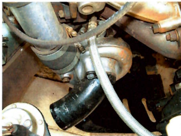
Fig.40-Turbocompressor A/R 0,60 sem de ar e esquema de pressurização
