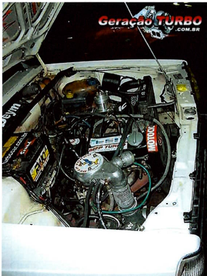
Fig.65-Motor VW 1,8L 8v turbinado
