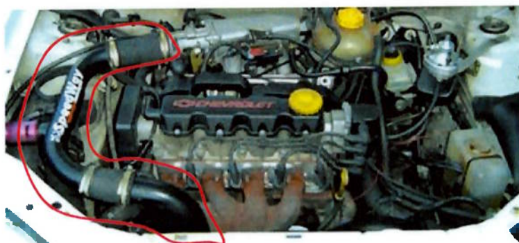
Fig.06–Sistema de admissão do ar de um GM Corsa
