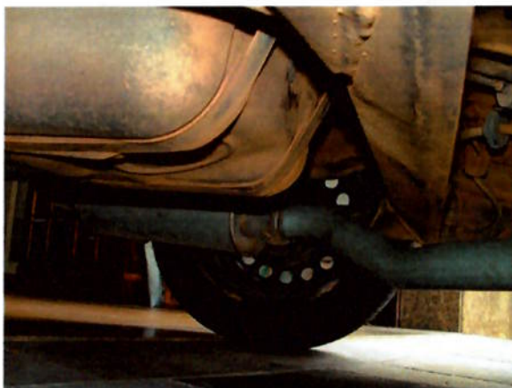
Fig.46-Tubulação 2 1/2 pol e abafador único
