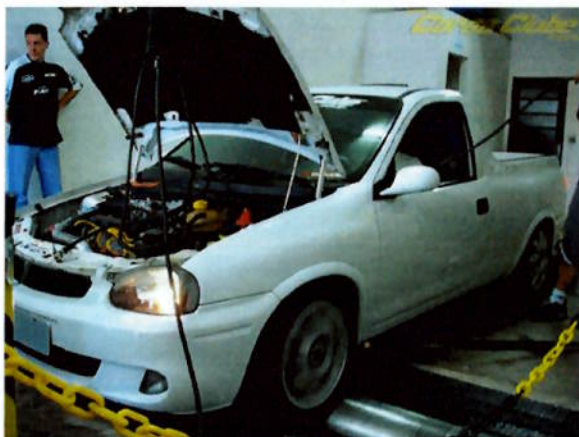
Fig.30—Medição em dinamômetro de rolo
