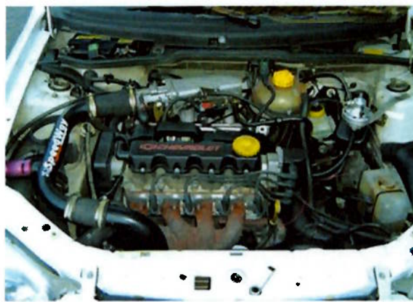
fig.35-Motor GM Fam I 1,0L turbinado
