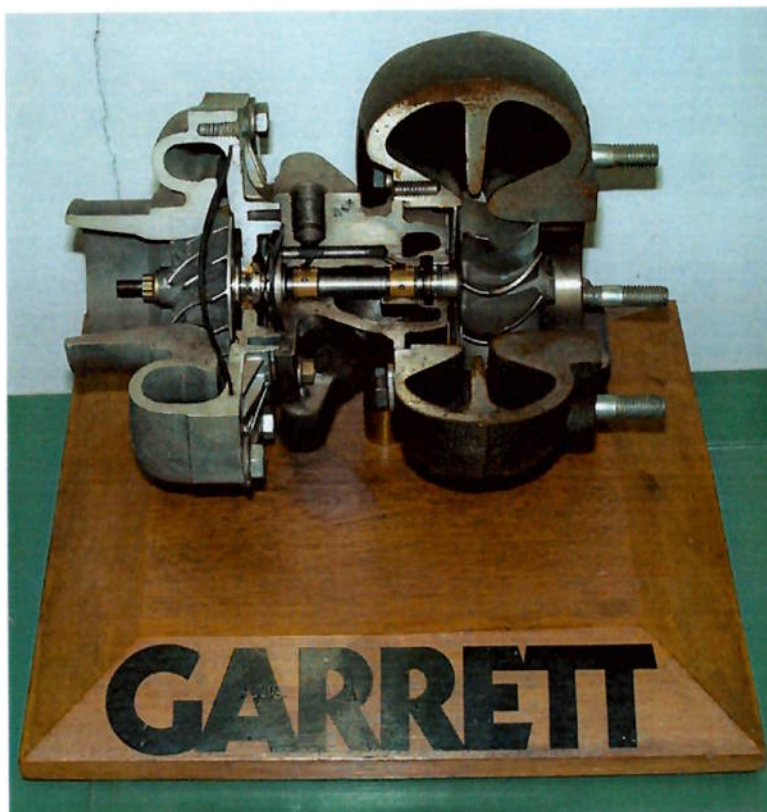
fig.03 – Turbocompressor da Garrett
