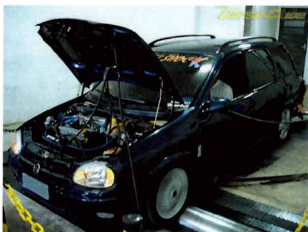
Fig.55-Medição em dinamômetro de rolo fig.56-Pressurização e corpo de borboleta
