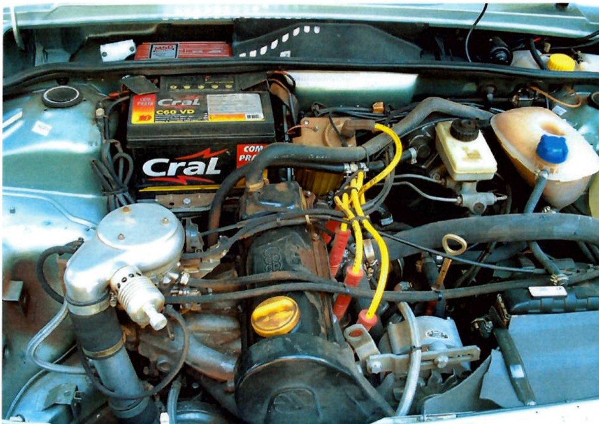
Fig.38-Motor VW AP 1,8L carburado
